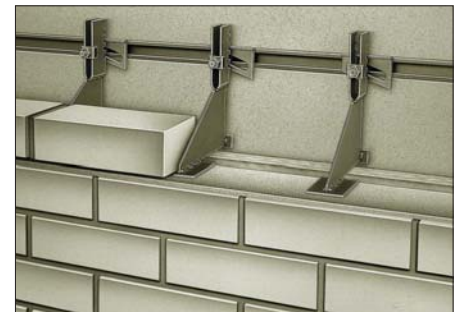
Рис. 2. Крепления для фасадов из кирпича
